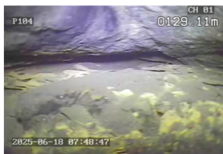
Foto 13. Fratura com quebra da rocha e arame perdido no poço
