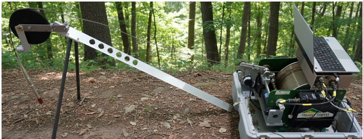
Figura 1. Conjunto de geofísica composto de guincho de geofísica, tripé, datalogger da MSI e notebook
