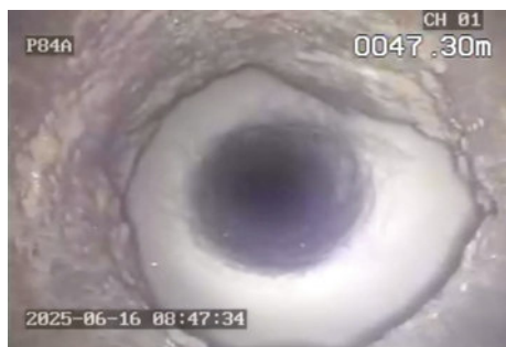
Foto 3. Detalhe do furo no revestimento em 39,9 m
