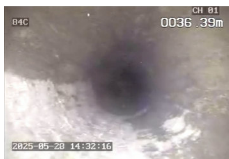
Foto 5. Sujeira escura incrustada na parede do Fratura com quebra da rocha
