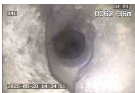
Foto 5. Sujeira escura incrustada na parede do Fratura com quebra da rocha
