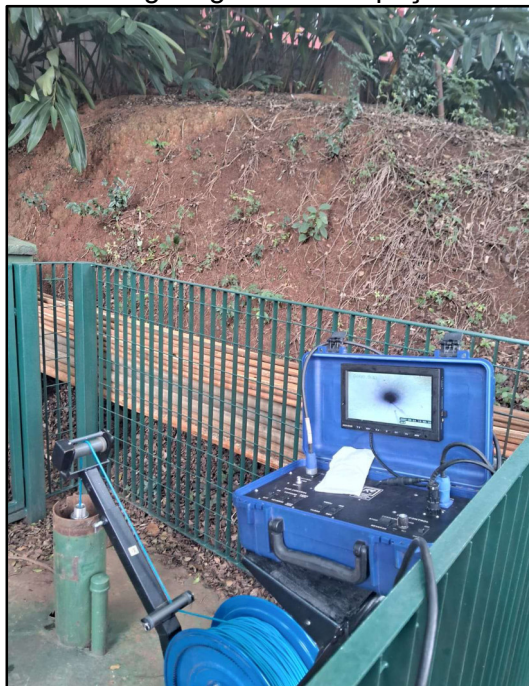
Figura 7: Perfilagem geofísica no poço ID IPT 320B.
