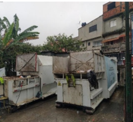
Compactadores Estacionários para descarte de resíduos, no município de São Bernardo do Campo
