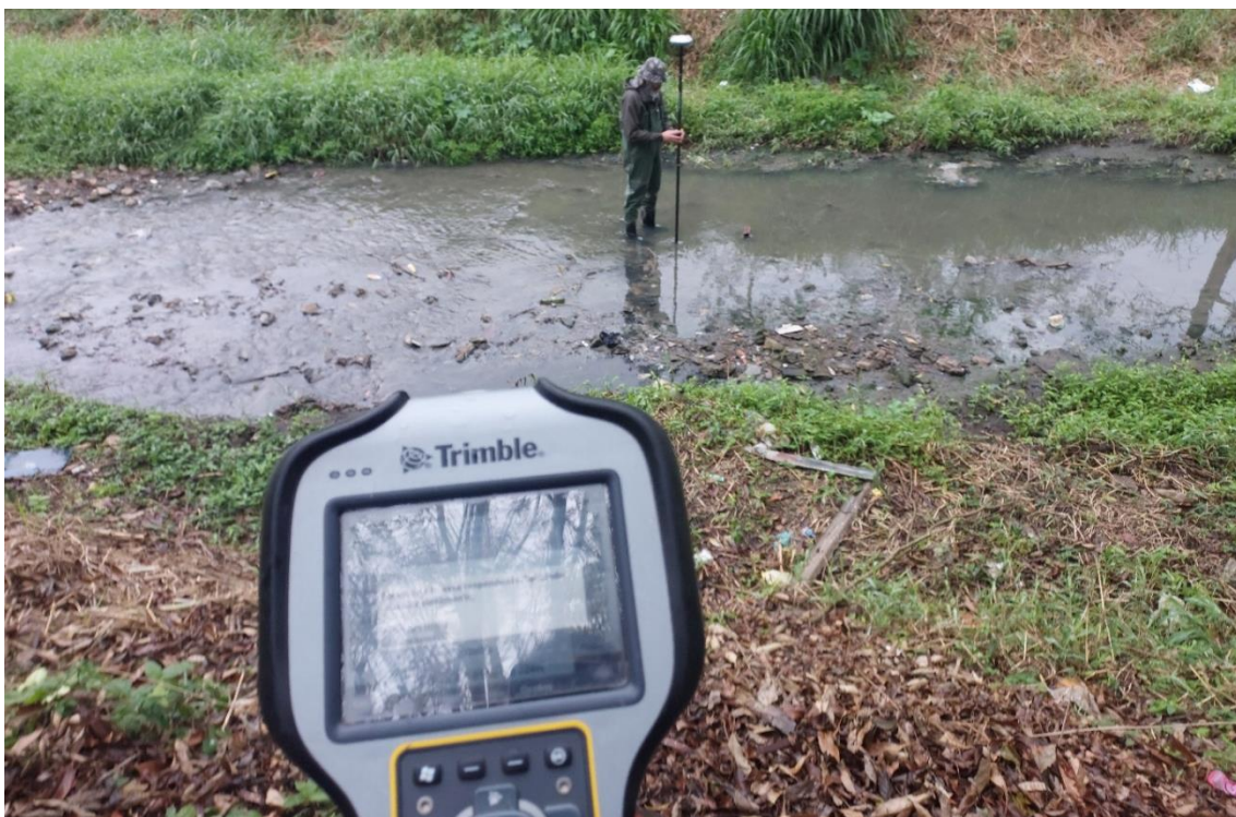
Figura 10: Topobatimetria na seção transversal do córrego Jaguaré.
