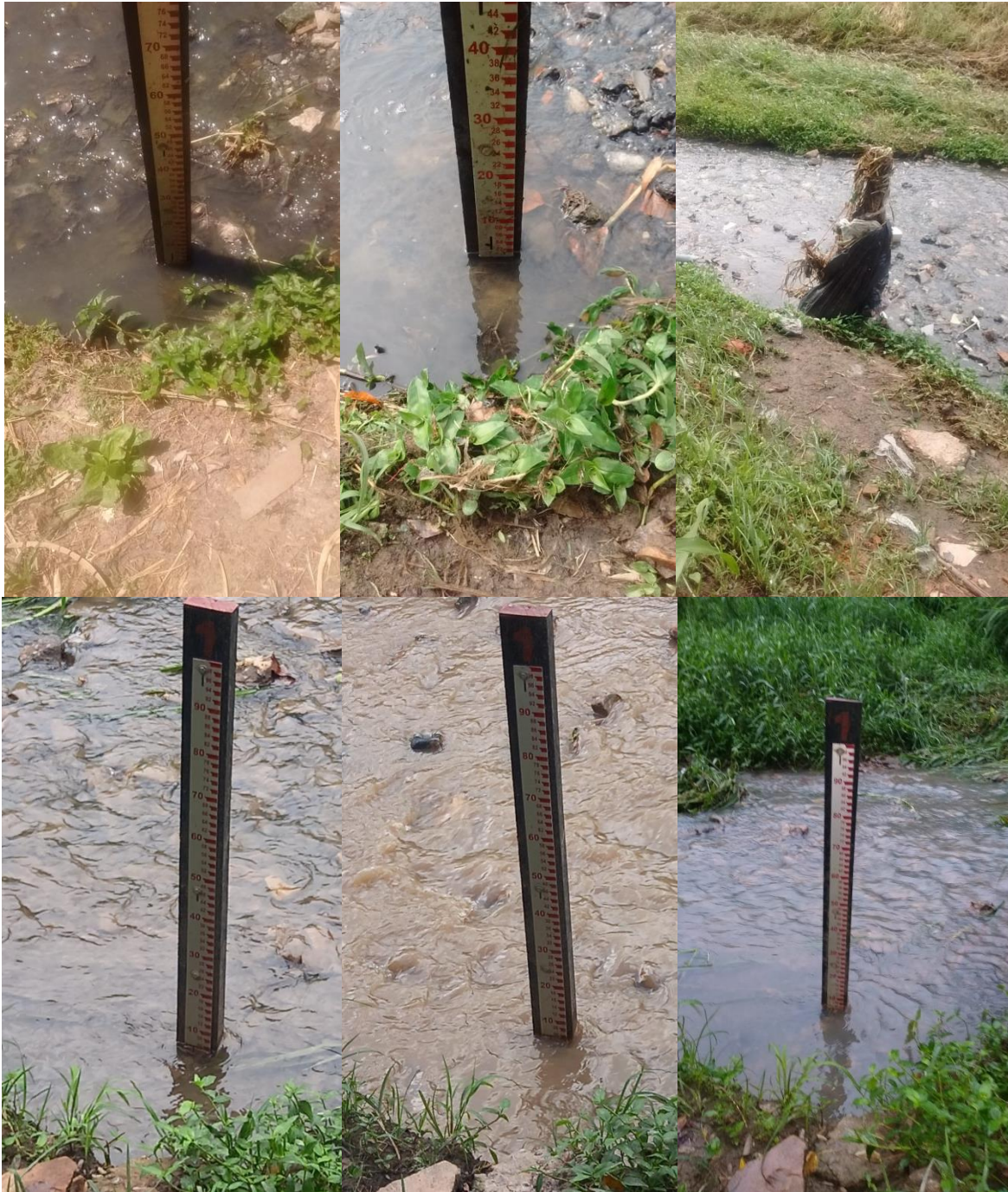
Figura 35: Leituras de nível d'água realizadas nas réguas instaladas na estação Jaguaré.
