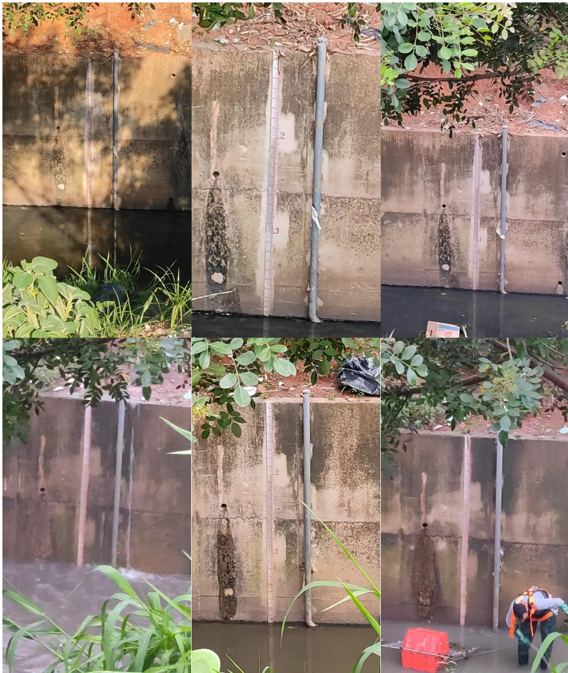
Figura 36: Leituras de nível d'água realizadas nas réguas instaladas na estação Novo Mundo.
