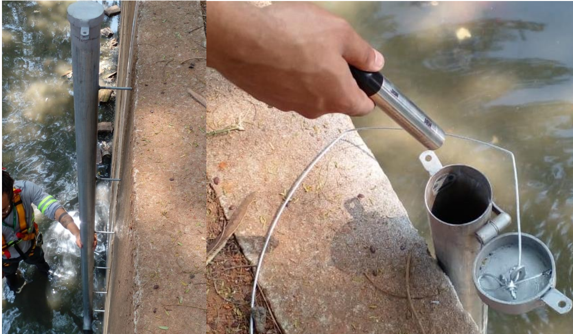
Figura 18: Sonda Onset HOB Water Level Logger U20-001-01 instalada na estação do córrego Novo Mundo.
