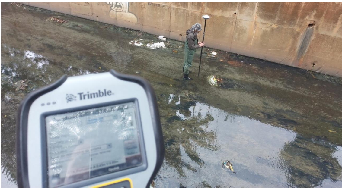
Figura 9: Topobatimetria na seção transversal do córrego Novo Mundo.
