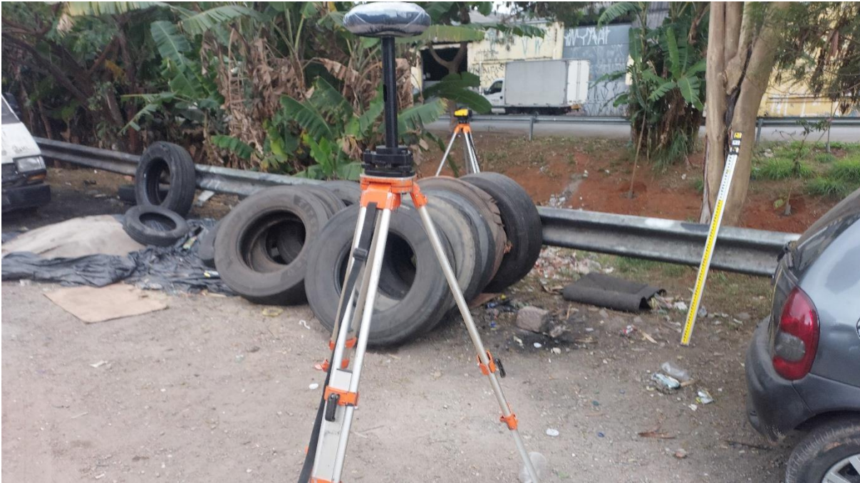
Figura 6: Rastreio do ponto de apoio do córrego Novo Mundo.
