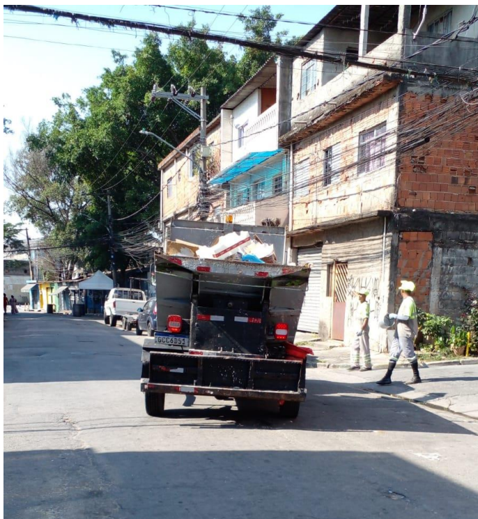
Figura 32: Coleta de resíduos indiferenciados na sub-bacia do Córrego Novo Mundo pela concessionária de coleta de resíduos com caminhão adaptado com caçamba de 7m 3 .
