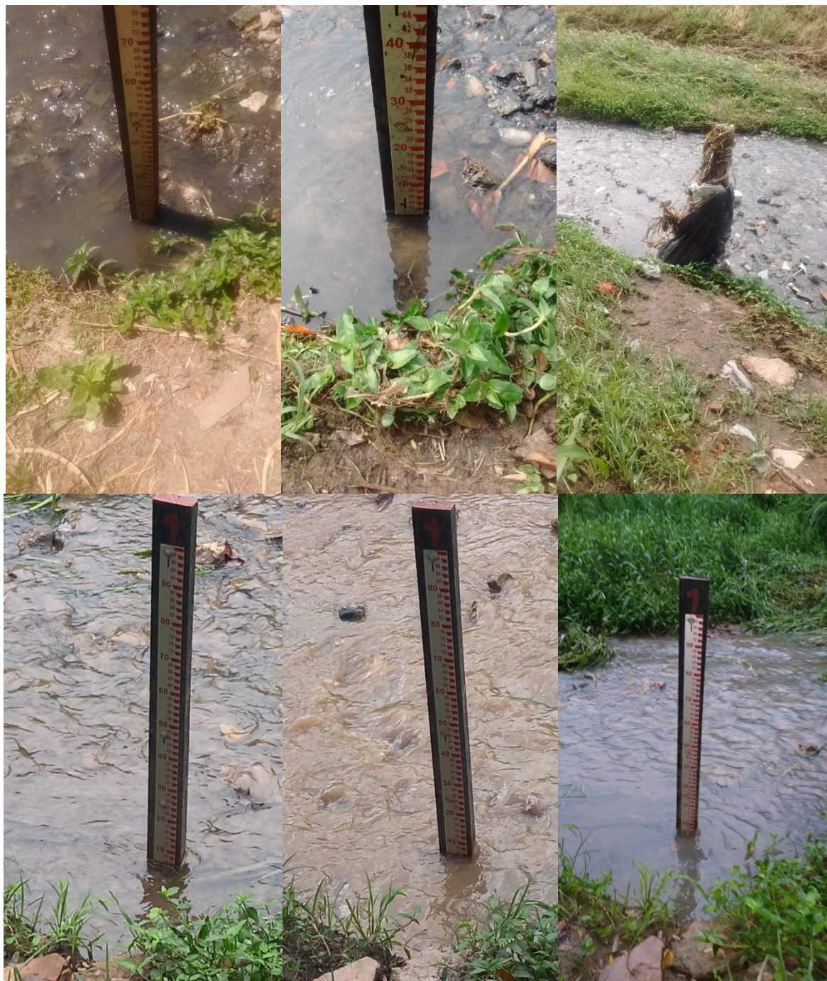
Figura 15: Leituras de nível d'água realizadas nas réguas instaladas na estação Jaguaré. Fonte: Elaborado por EnvEx Engenharia e Consultoria (2024).
