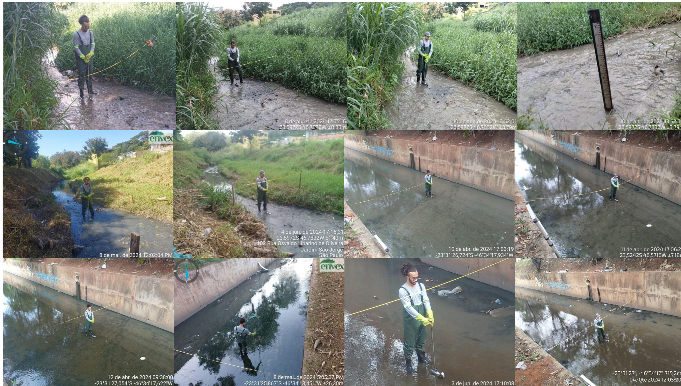
Figura 7: Registros fotográficos das campanhas de monitoramento de vazões nas estações do Jaguaré e Novo Mundo no período de abril a junho.
