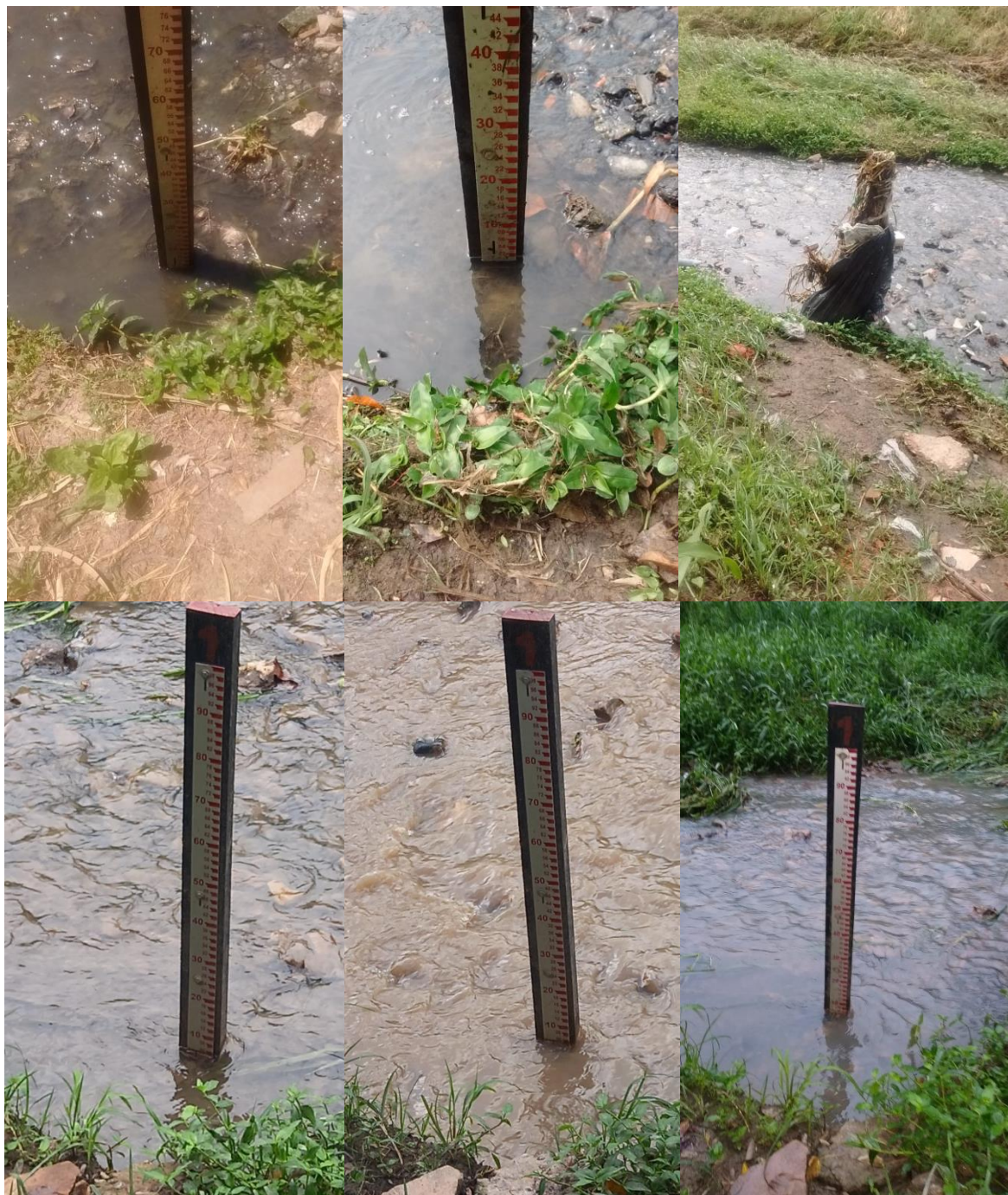
Figura 11: Leituras de nível d'água realizadas nas réguas instaladas na estação Jaguaré.
