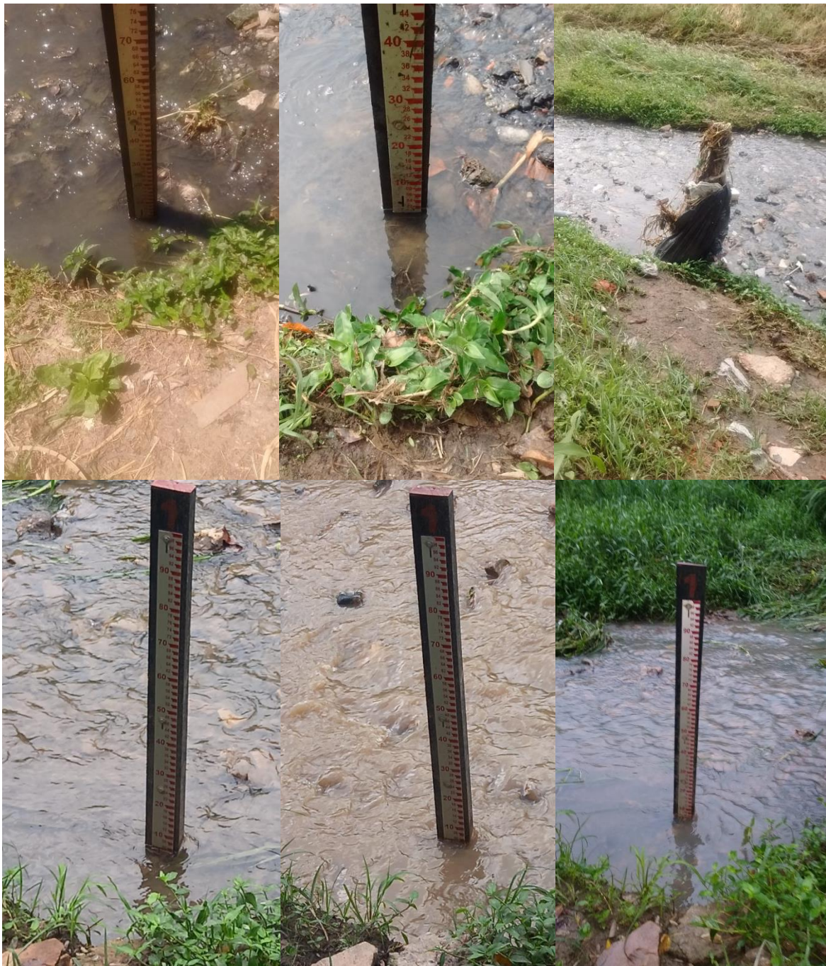
Figura 9: Leituras de nível d'água realizadas nas réguas instaladas na estação Jaguaré.
