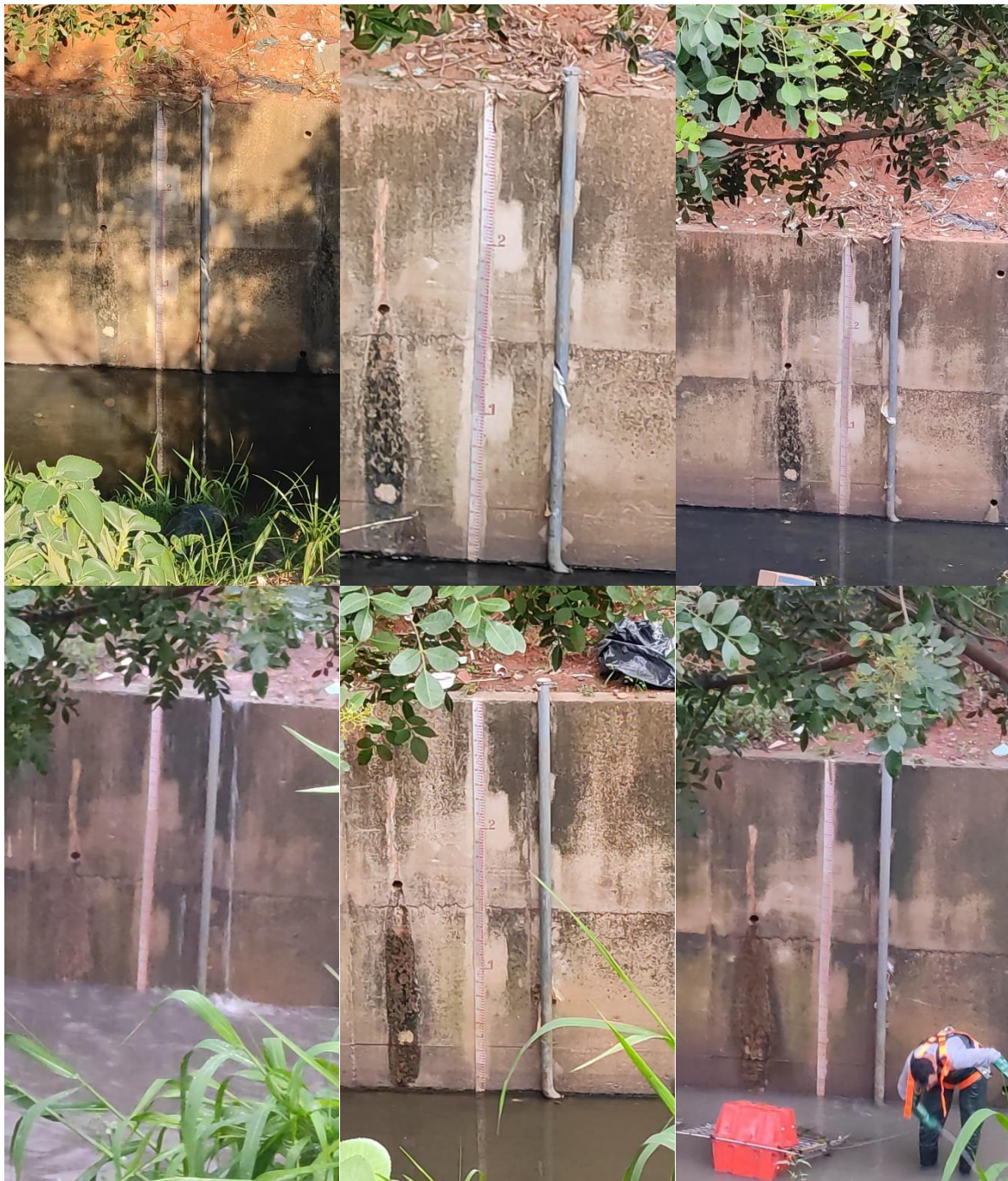
Figura 10: Leituras de nível d'água realizadas nas réguas instaladas na estação Novo Mundo.
