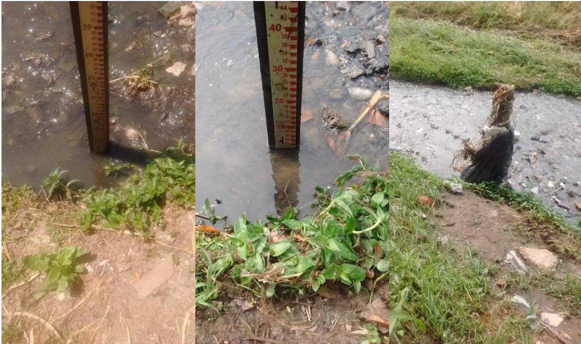
Figura 8: Leituras de nível d'água realizadas nas réguas instaladas na estação Jaguaré.
