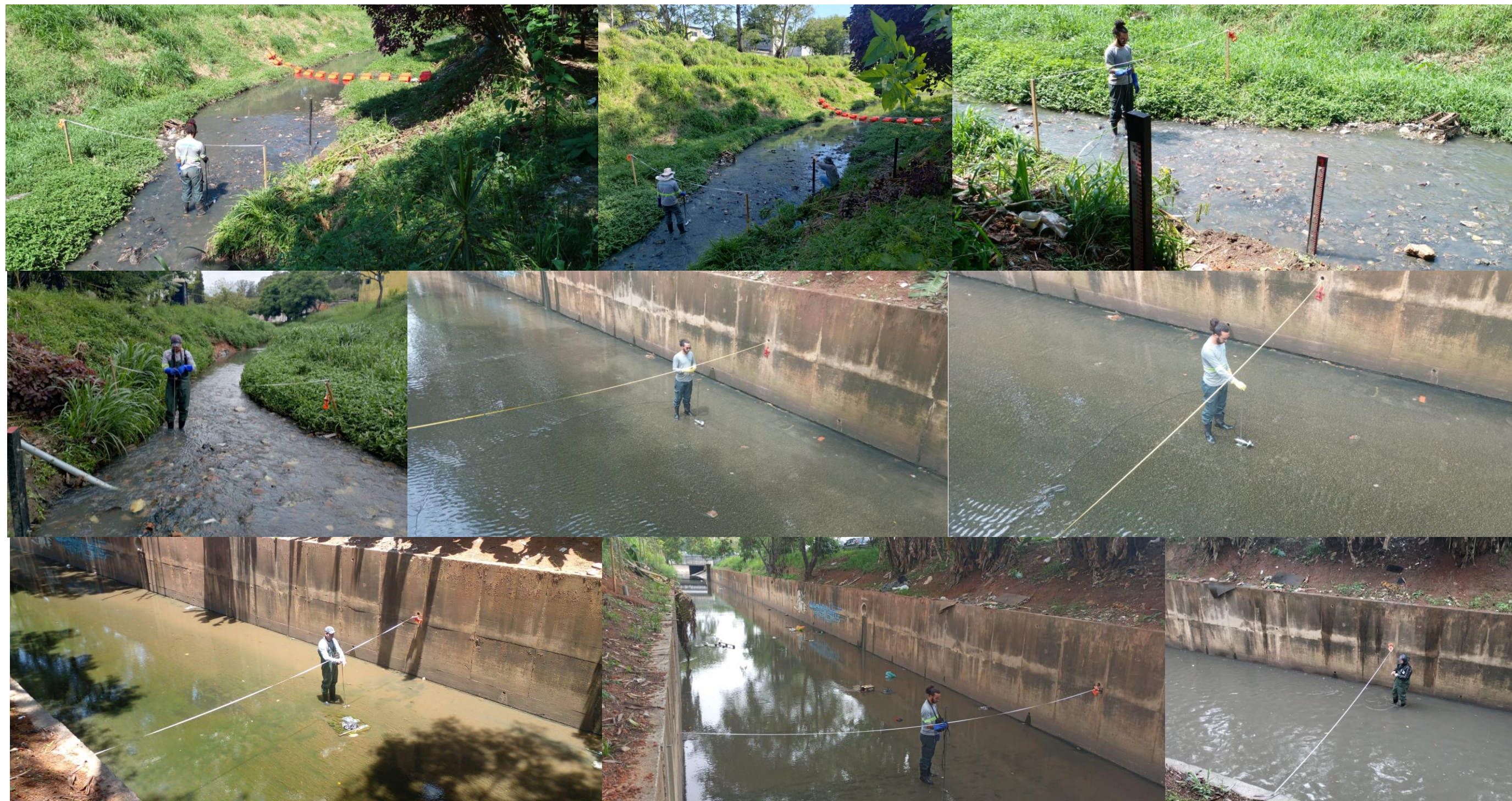
Figura 5: Registros fotográficos das campanhas de monitoramento de vazões nas estações do Jaguaré e Novo Mundo. Fonte: Elaborado por EnvEx Engenharia e Consultoria (2023).
