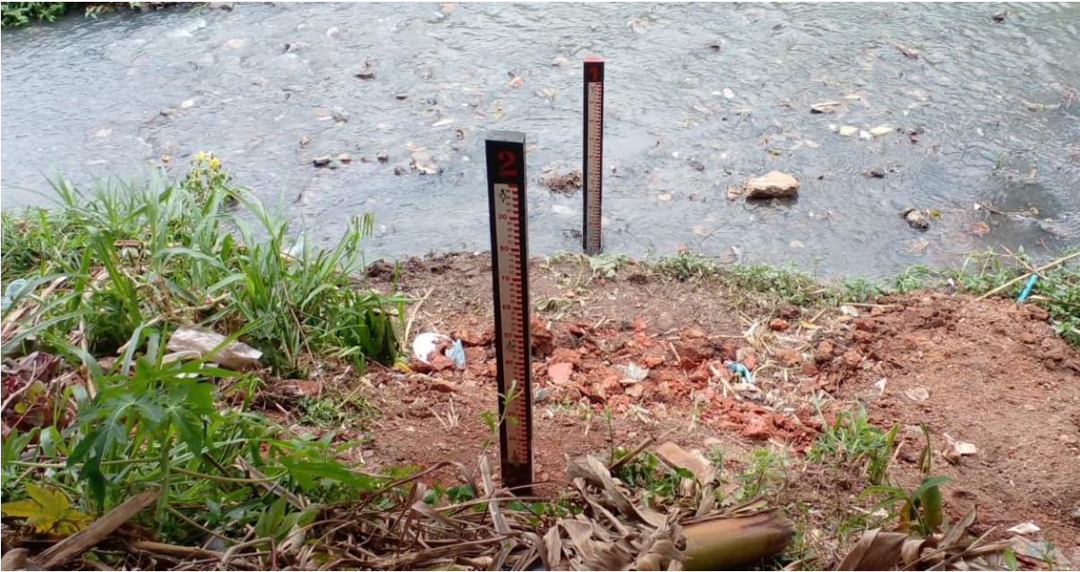
Figura 14: Réguas Linimétricas instaladas no córrego Jaguaré.
