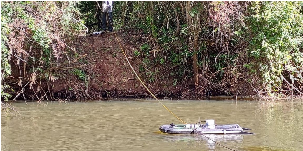
Figura 9: Medição de vazão com ADCP Sontek M9
