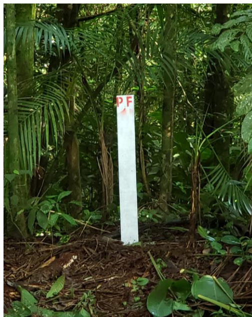
Figura 6: Exemplo de instalação de marcos PI e PF em estações fluviométricas.
