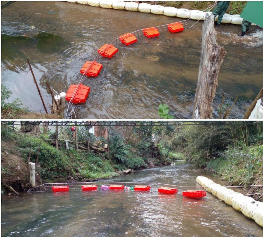
**Figura 36: Barreira flutuante em fase de testes.**
