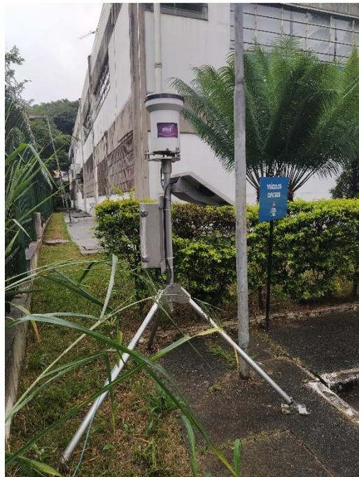
**Figura 30: Estação de monitoramento pluviométrico do CEMADEN existente na sub-bacia do Córrego Novo Mundo.**
